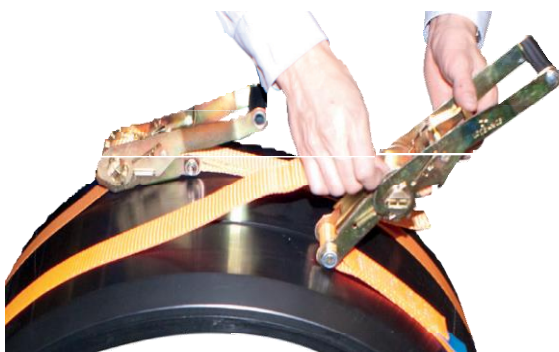
Obrázek A.23: Provláknutí upínacího pásu
