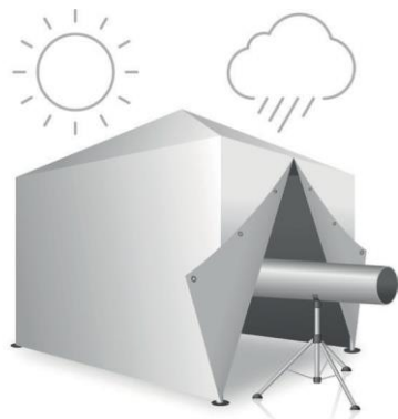
Obrázek A.1: Příprava svařovaného místa podle DVS.
