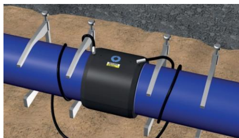
Obrázek A.17: Připojení svařovacích kontaktů
