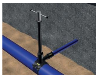
Obrázek A.40: Navrtání potrubí
